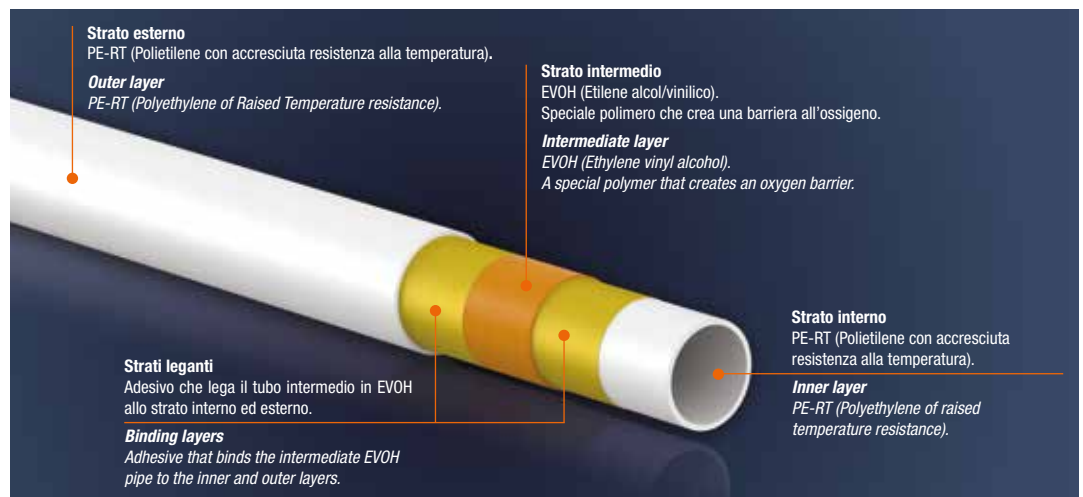
Stratigrafia tubo polipert Polipert pipe stratigraphy
